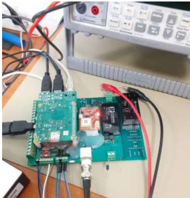
Figura 4 Carrier – board pentru Raspberry Pi 4
