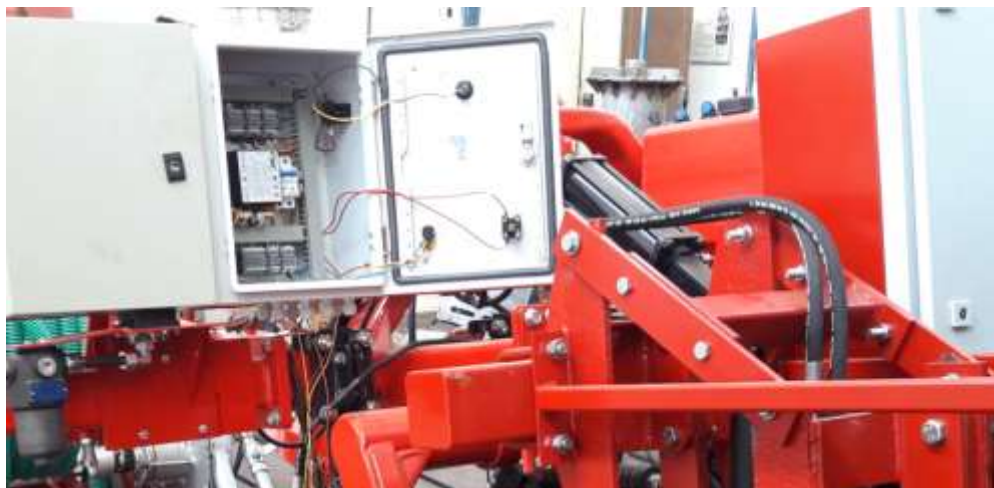
Figura 2. Dispunerea senzorilor și a sistemului electrohidraulic pe platforma tractată
